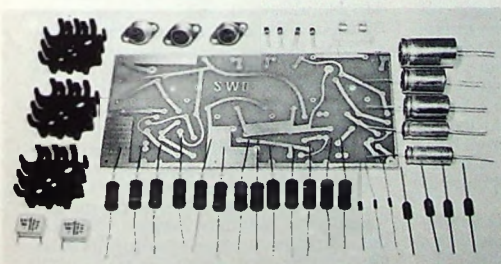
Bild 4. Printplatte für den eisenlosen Gleichspannungswandler (Maßstab 1:2)
